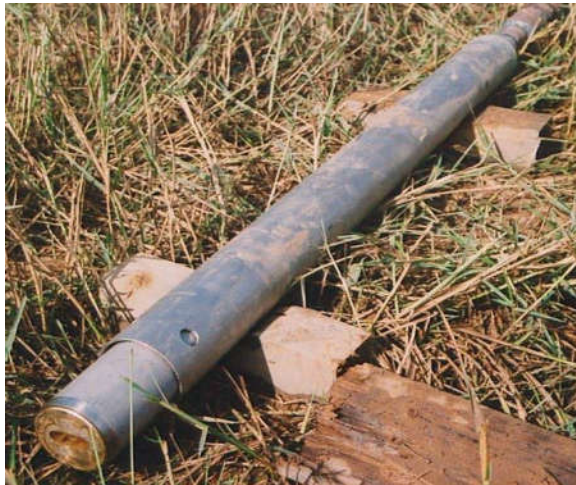
Hình 3: Ống mẫu Piston Osterberg
